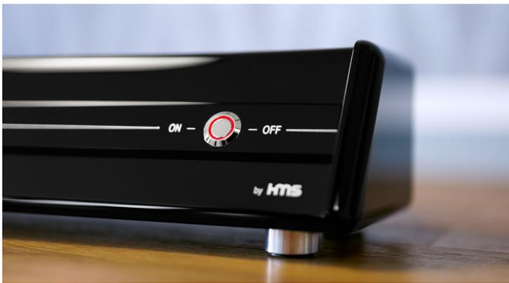
Hinter dem Ein-Aus-Schalter beider Leisten steckt eine Soft On/Soft Off-Schaltung. Sie sorgt dafür, dass alle Komponenten schonend eingeschaltet werden. Bei Komponenten wie Leistungsverstärkern, die beim Einschalten sehr schnell viel Strom ziehen, verhindert die Soft On-Funktion, dass die Sicherung der Wohnung auslöst. Der illuminierte Ring, der den Schalter umgibt, zeigt den Betrieb an. Hier ist er in Rot ausgeführt, auf Wunsch wird er alternativ in Blau oder Grün realisiert.
