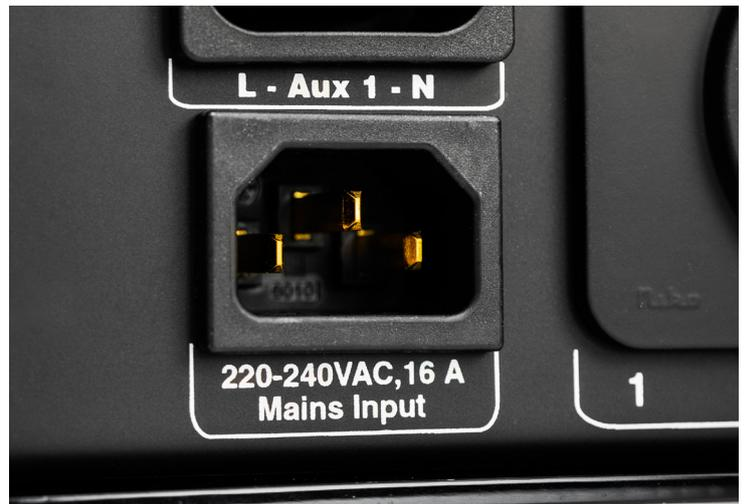
Der Kaltgeräte-Einbaustecker dient dem Anschluss des mitgelieferten Netzkabels, welches von der Wandsteckdose kommt. Hinter dem Anschluss sitzt eine Schaltung zur Phasenerkennung: Das Einschalten der Energia RC-Leisten ist nur möglich, wenn der Stecker in der Wandsteckdose „richtig herum“ eingesteckt ist.
