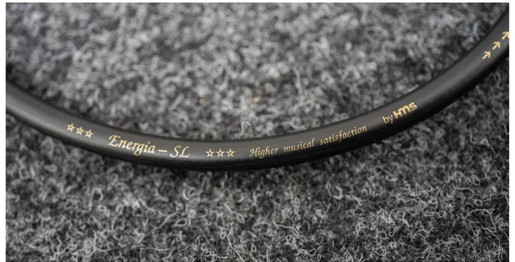
*Der Mantel des Energia SL/V besteht aus Polyurethan. Dank dieses robusten Kunststoffes ist das Kabel resistent gegen mechanische Beanspruchung. Trotzdem erweist es sich als überaus flexibel. Dadurch ist ein geringer Biegeradius von 70 Millimeter möglich. Auch das ist ein Pluspunkt bei der Handhabung.*
