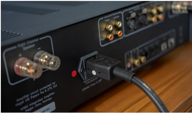
**Phasenrichtiger Anschluss:** Das HMS-Netz-kabel zeigt die Phasen-Führung mit einem weißen Punkt an, bei unserem Verstärker haben wir denn Phasen-Kontakt ebenfalls mit einem Punkt gekennzeichnet.
