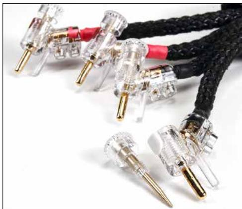
Die gängigste Konfektionierung ist die mit den „Nextgen“-Bananas von WBT, bei denen ein Dorn über ein Drehgewinde den Kontaktstift spreizt (v.).
