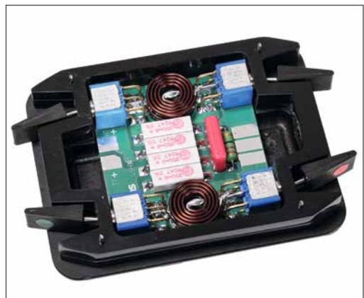
Im Innern der „Black Box“ ermöglichen elektronische Bauteile ohmsche wie induktive Anpassungen zwecks klanglicher Feinabstimmung.
