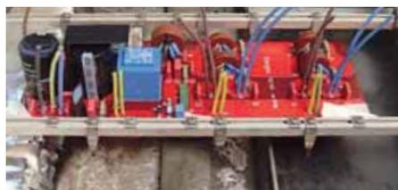
Moderne Präzisionsfertigung für HMS in Leverkusen: eine Filterplatte im Lötbad
